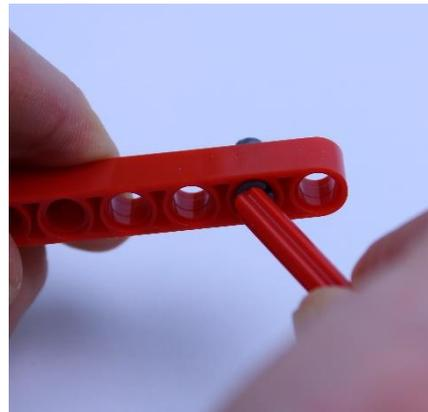
2. Si vous devez monter ou démonter une roue, un bloc, un connecteur, un engrenage, etc. sur un arbre, il peut être utile d'utiliser un grand bras.
