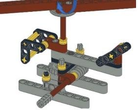
Lorsque nous tournons la poignée dans le sens des aiguilles d'une montre, la vis sans fin tourne. La roue dentée sur laquelle les lames sont montées tournera dans le sens anti-horaire à une vitesse de :
