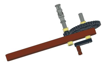
En retirant la poignée de la roue menante de l'hélicoptère, le moteur peut être fixé à la roue menante. Si le levier du moteur est ensuite tourné, cela fournit un rapport de transmission de
