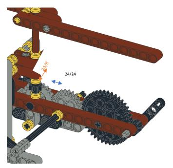
L'axe menant est relié à une roue à **24** dents. Cette roue entraîne les pales d'une part et le rotor de queue d'autre part.
