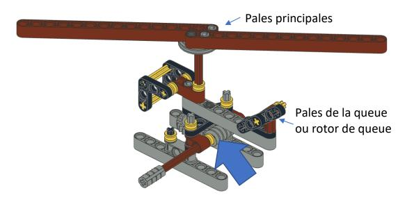
**Exemple 2**: Actionnées par une couronne et un certain nombre d'engrenages linéaires, les pales tourneront plus vite que l'entraînement du moteur, tandis que la roue de queue tournera aussi vite que les pales principales. Cette façon de faire n'est pas non plus idéale car ce n'est pas le cas avec un véritable hélicoptère.
